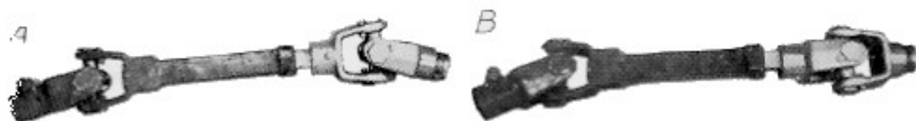
Bild 276. Hopkoppling av krafttuttagsaxelns kopplingshylsa och fyrkantaxel. A riktig. B fel.
